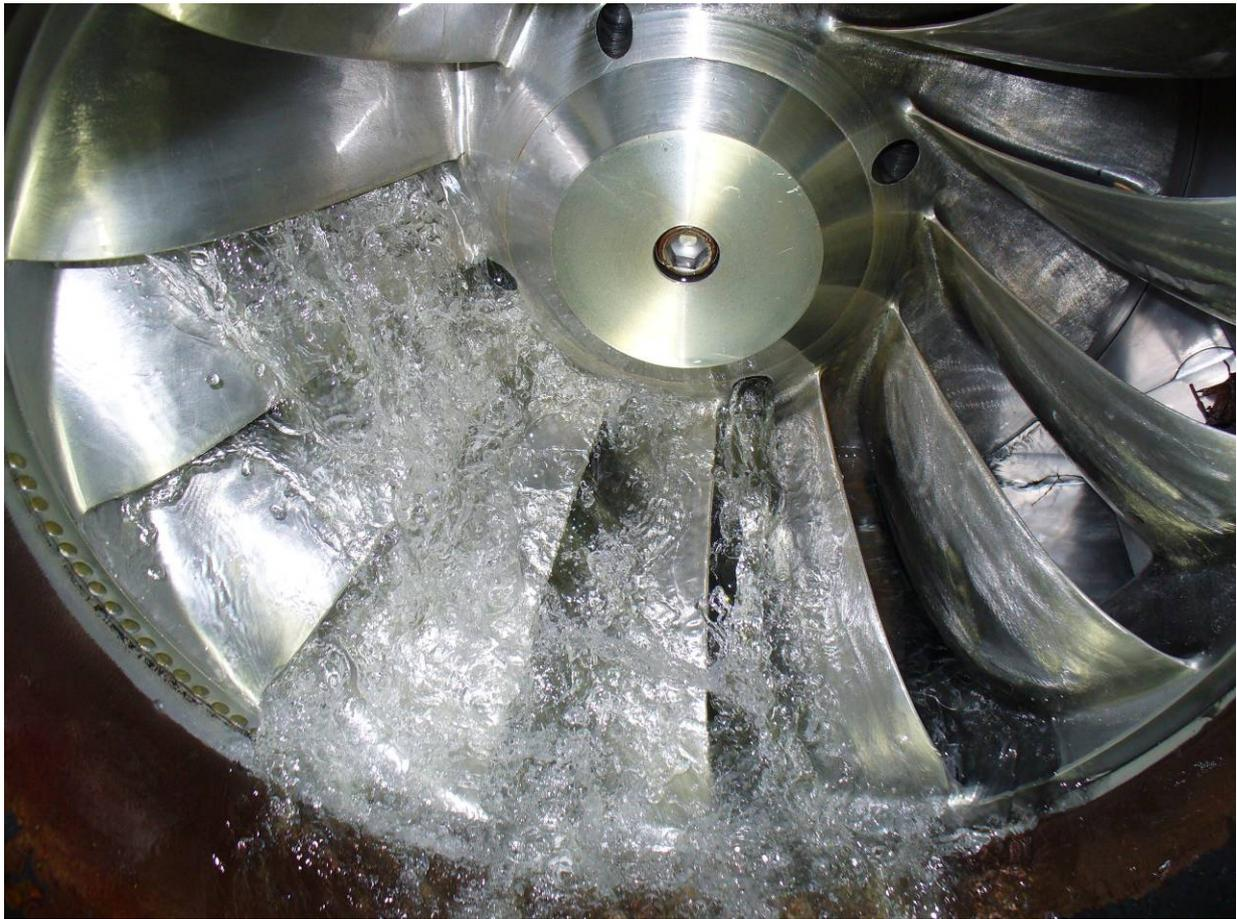
**La turbina Francis**, frequentemente utilizzata sugli impianti idroelettrici è una turbina a reazione sviluppata nel 1848 da James B. Francis, un ingegnere inglese trasferitosi negli Stati Uniti.
