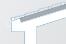
*strato di isolamento termico su copertura a falda*
