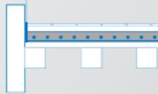
*strato di isolamento termico e alleggerimento su solai in legno*
