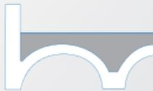
*livellamento - riempimento leggero termoisolante di solai a volti*
