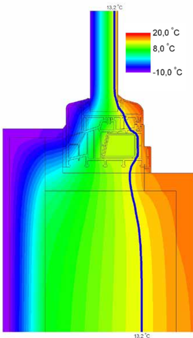
► Formazione di muffa causata da un ponte termico.
