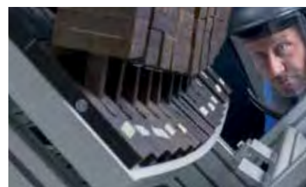
Test carico di neve
