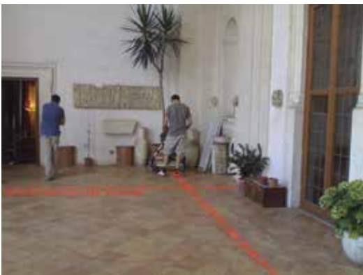
Fase di acquisizione dati radar attraverso scansioni longitudinali e trasversali della pavimentazione
