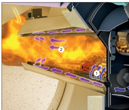
Combustione a 2 stadi nella caldaia BioLyt (50-160): gassificazione del legno (1) e combustione secondaria (2).
