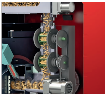
La doppia valvola stellare della caldaia BioLyt (100-160) rende possibile il caricamento del contenitore del pellet con bruciatore in funzione.
