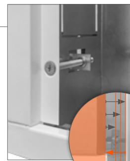
**Copertura con cornice telescopica** che permette la compensazione dello spessore dell'intonaco estendendo la profondità da 80 a 130 mm.
