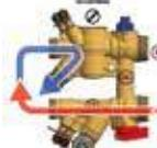
Lavaggio dell'unità terminale con acqua dal circuito primario - cartuccia PICV disinserita.
