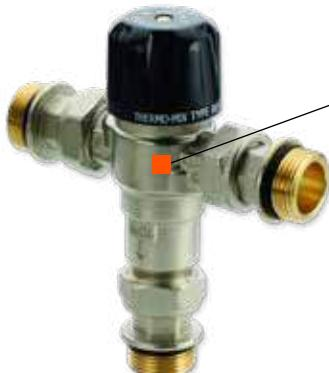
Termostato ad espansione di cera che si allunga e si accorcia in funzione della temperatura percepita
