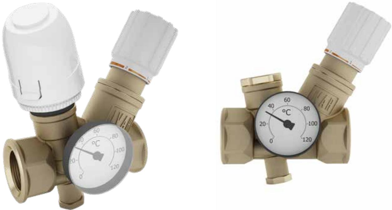
RTV è una valvola proporzionale automatica con inserto termostatico che controlla la portata nei circuiti di ricircolo affinché la temperatura nelle tubazioni si mantenga a un valore desiderato, limitando le dispersioni termiche. In questo modo si assicura il massimo comfort agli utilizzatori dell'impianto, che avranno sempre l'acqua calda alla giusta temperatura.
