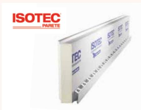
**Isotec Parete** è un sistema funzionale alla realizzazione di facciate ventilate che consente di comporre a secco in un'unica soluzione tecnica un isolamento in poliuretano e una struttura di supporto per la finitura esterna di rivestimento. Il correntino portante forato forma una camera d'aria ventilata tra pannello isolante e finitura di facciata.
