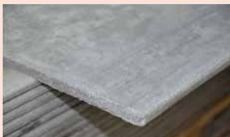
**Elycem** è una lastra in cemento Portland alleggerita con inerti minerali e rinforzata sui due lati con doppia rete in fibra di vetro. L'elevata resistenza meccanica, la durabilità, la velocità d'installazione, la facilità di finitura consentono ad Elycem di essere installata quale lastra di finitura nelle pareti esterne degli edifici realizzati con sistema a secco o misto, tanto nelle nuove costruzioni quanto nelle ristrutturazioni.
