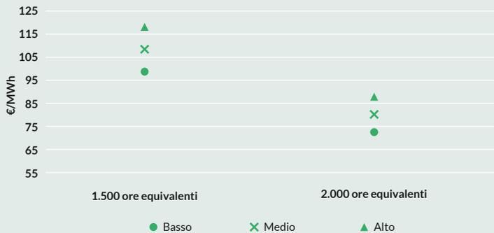
**Nota:** Il range di valori (Alto, Medio, Basso) è ottenuto facendo variare i CAPEX dell'impianto fotovoltaico tra 900 e 1100 €/kW, e i CAPEX della batteria tra 240 e 290 €/MWh.
